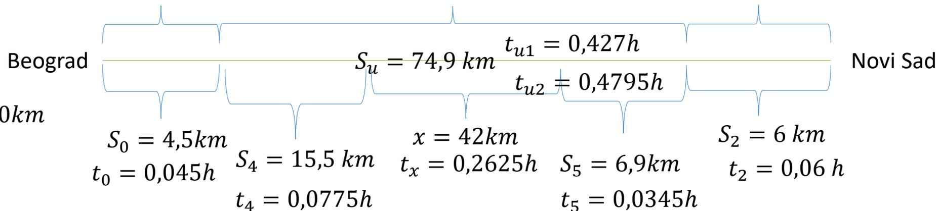
$$t_{u2} = t_0 + t_4 + t_x + t_5 + t_2$$
