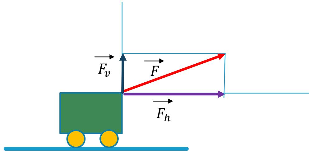
Postupak suprotan od slaganja sila je razlaganje sile. Jednu silu razlažemo na dve komponente. To je postupak kada od rezultante dobijamo komponente.
