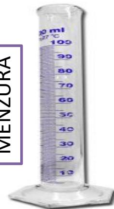
Zapremina tečnosti se direktno meri menzurom – cilindrični sud na čijem zidu je skala najčešće u  $\text{cm}^3$ , odnosno ml.
